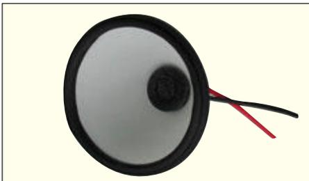
**Bild 6: Experimentieranordnung für ein Stethoskop-Mikrofon. Deutlich erkennt man die Gummilagerung der Mikrofonkapsel und die dicke Gummidichtung für den luftdichten Abschluss.**
